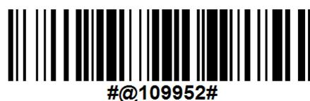
Примечание: Устройство всегда автоматически перезагрузится после считывания многофункционального штрих кода при (1) смены интерфейса ввода (2) включения/выключения режима работы с памятью. Сканер ответит длинным тональным сигналом и светодиодные индикаторы загорятся и погаснут.
