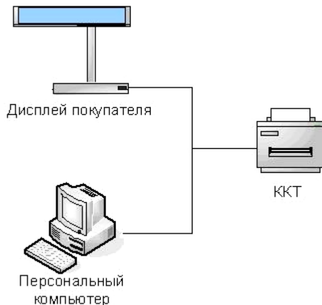
Рисунок 11. Подключение управляющих устройств к ККТ
