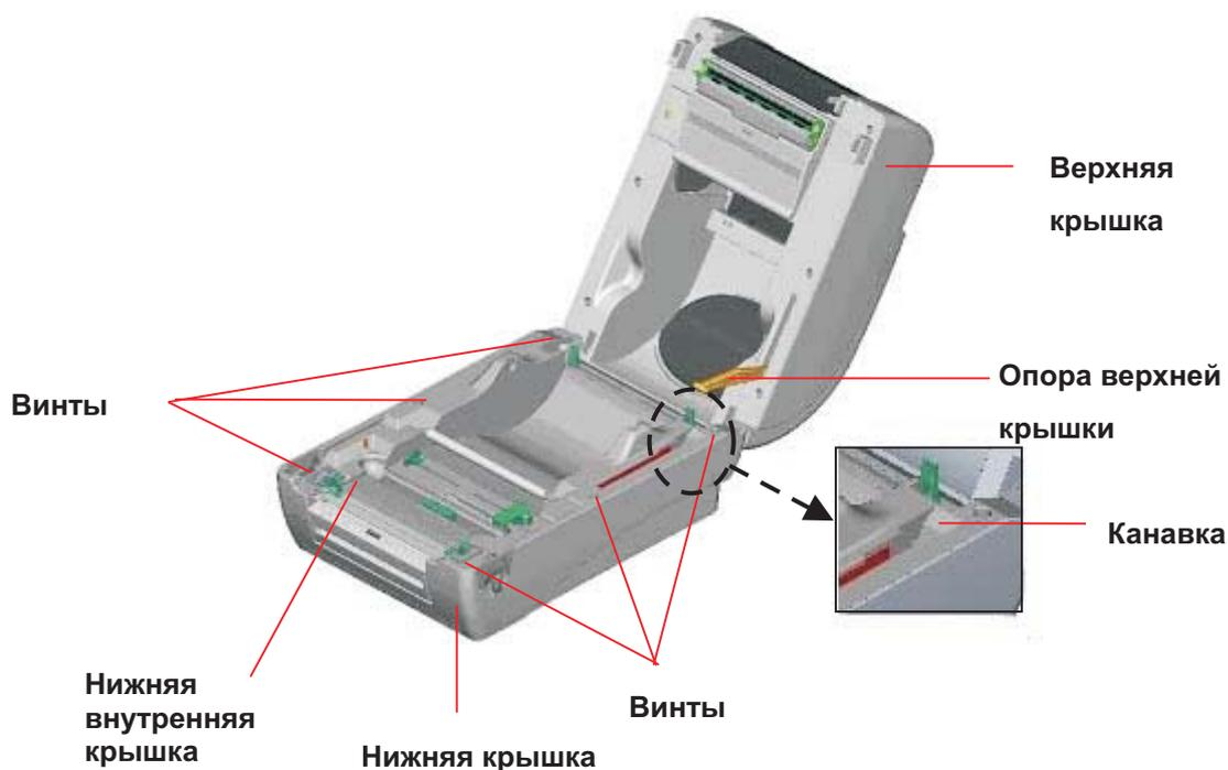
**Рис. 13. Отверните 6 винтов нижней внутренней крышки**
