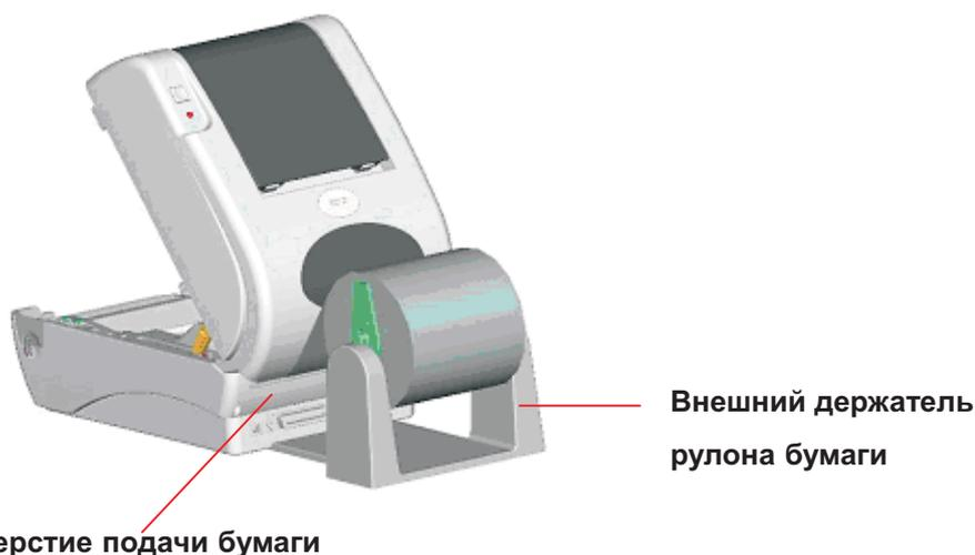
**Рис. 10. Установка внешнего держателя рулона этикеток (I)**
