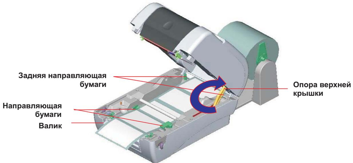
Рис. 11. Установка внешнего держателя рулона этикеток (II)
