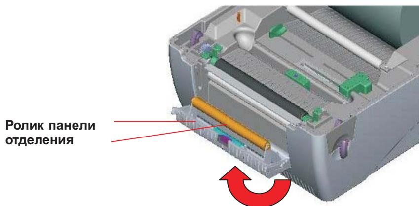
**Рис. 17. Установка панели отделения (II)**
