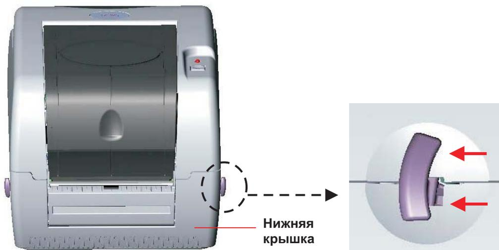
**Рис. 7. Потяните фиксатор на себя для открытия крышки**
