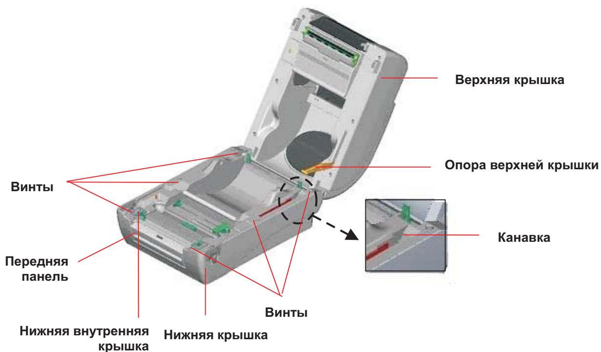
**Рис. 23. Отверните 6 винтов нижней внутренней крышки**
