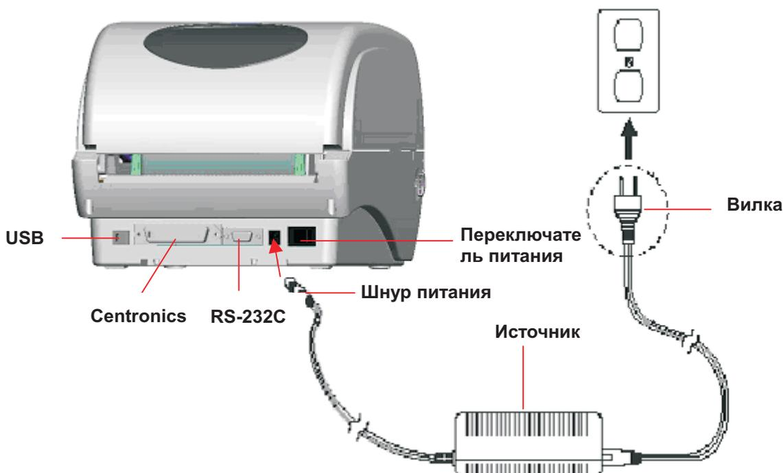
Рис. 3. Подключение источника электропитания к принтеру
