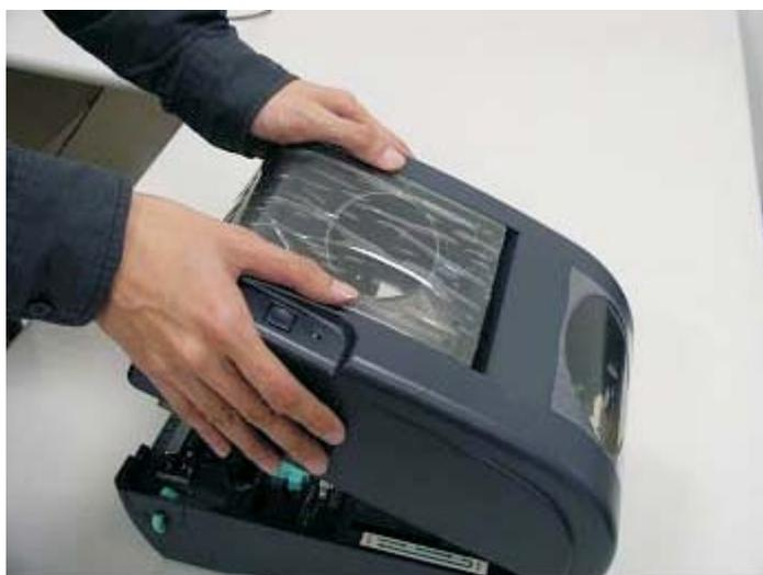
Рис. 3. Закрывают верхнюю крышку двумя руками
