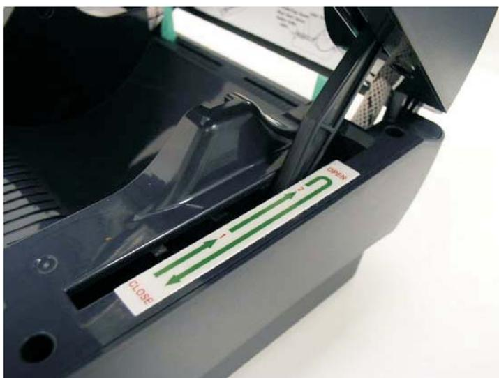
Рис. 1 Опора верхней крышки зафиксирована в положении 2
