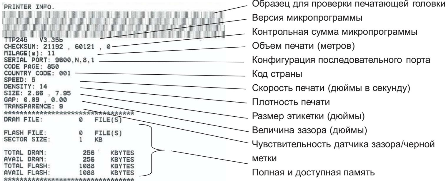
Рис. 29. Распечатка самопроверки
