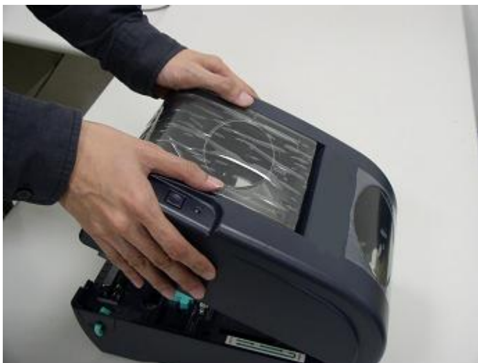
Рис. 3. Закрывайте верхнюю крышку двумя руками
