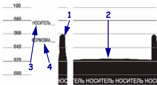
Рис. 29 • Профиль датчика (участок носителя)
