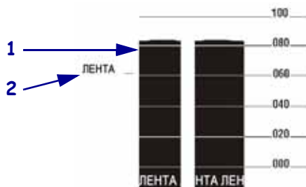
Рис. 28 • Профиль датчика (участок ленты)
