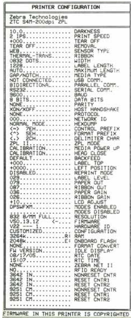
Рис. 17 • Образец этикетки с конфигурацией принтера
