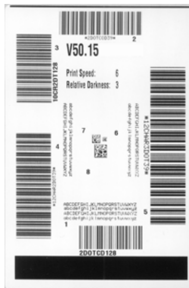
Рис. 25 • Этикетка при тестировании с помощью клавиши FEED (ПОДАЧА)
