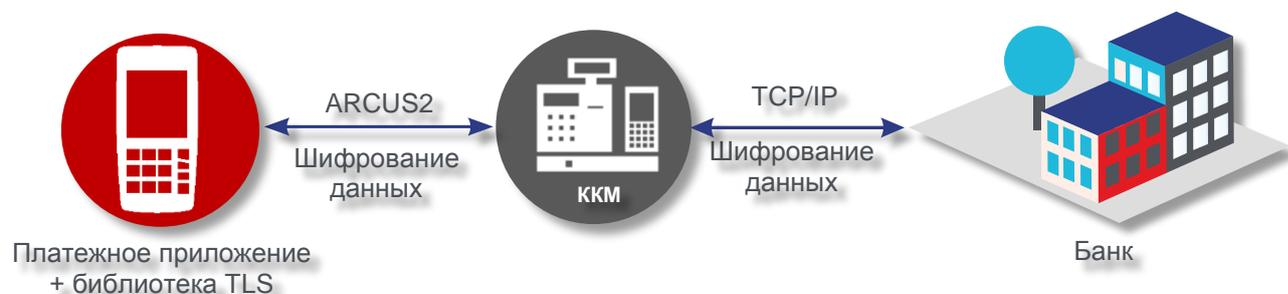
Рис. 2. TLS шифрование в режиме IP через кассу
