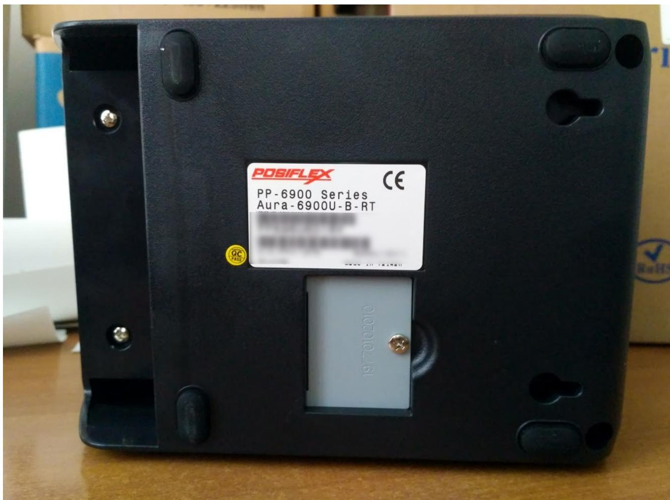
*Откручиваем крышку на дне устройства*
