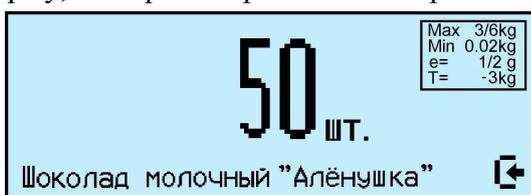
При использовании счетной функции допускается тарирование кнопкой **T** и предварительная установка тары.
