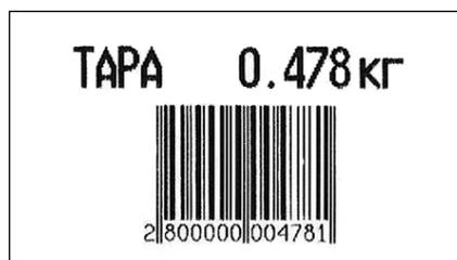
При считывании бирки сканером, терминал устанавливает значение тары см. п. 5.3.1.2. Бирка может быть наклеена, например, на телегу для перевозки груза.
