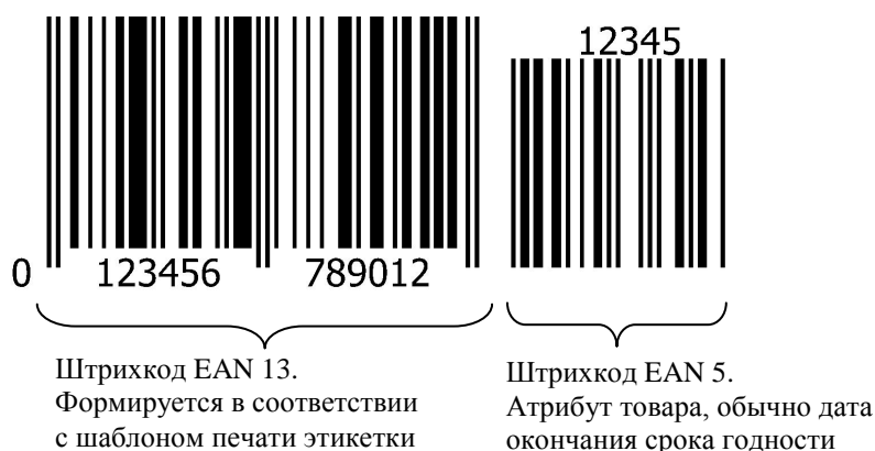
Рис. 7.2 - Структура штрихкода EAN 13+5
